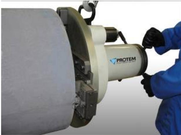
La machine à chanfreiner portable modèle US 150-24" est conçue pour le chanfreinage, le dressage, le délardage, le détubage, la mise à longueur de pipes et tubes de Ø150 mm intérieur à Ø 610 mm extérieur. Le plateau porte-outil peut être équipé de 4 portes outils permettant de réaliser individuellement ou simultanément différents usinages.
